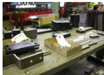
FO-3015で加工されたブランク材。そのまま出荷する部材と後加工の曲げに回る仕掛かり品とに種別される。
