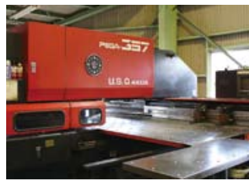
デジタル化のキッカケとなったパンチングマシンPEGA-357。
