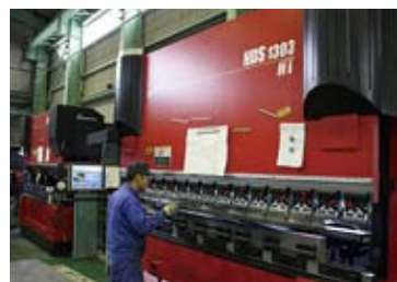
HDS-8025NTと手前のHDS-1303NTの2台を使った曲げ加工。曲げで滞ることはなくなった。
