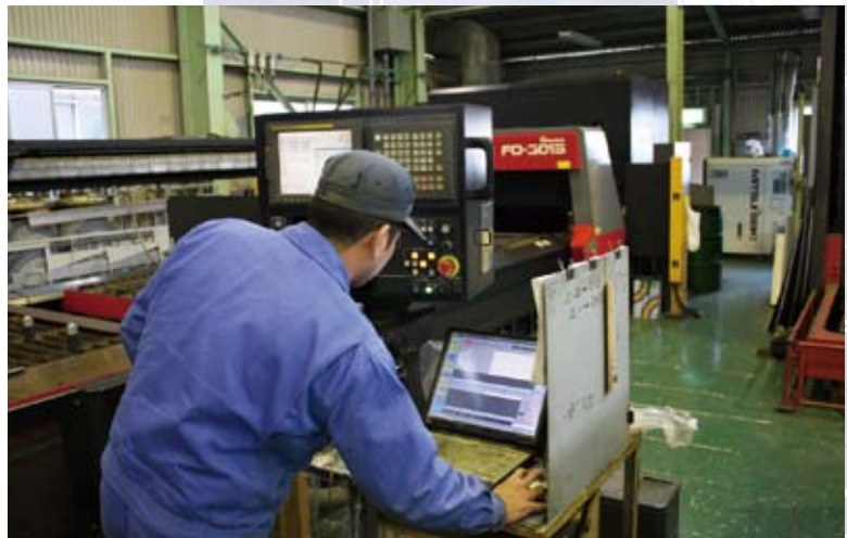
FO-3015はPEU/Winを通してプログラム室のAP100とリンクして、ネ스팅データを読み出して加工を行う。
