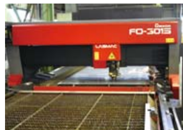
レーザーマシンFO-3015による加工。搭載するレーザー発振器は3kWで、切断する材料の最大板厚は16mm。
