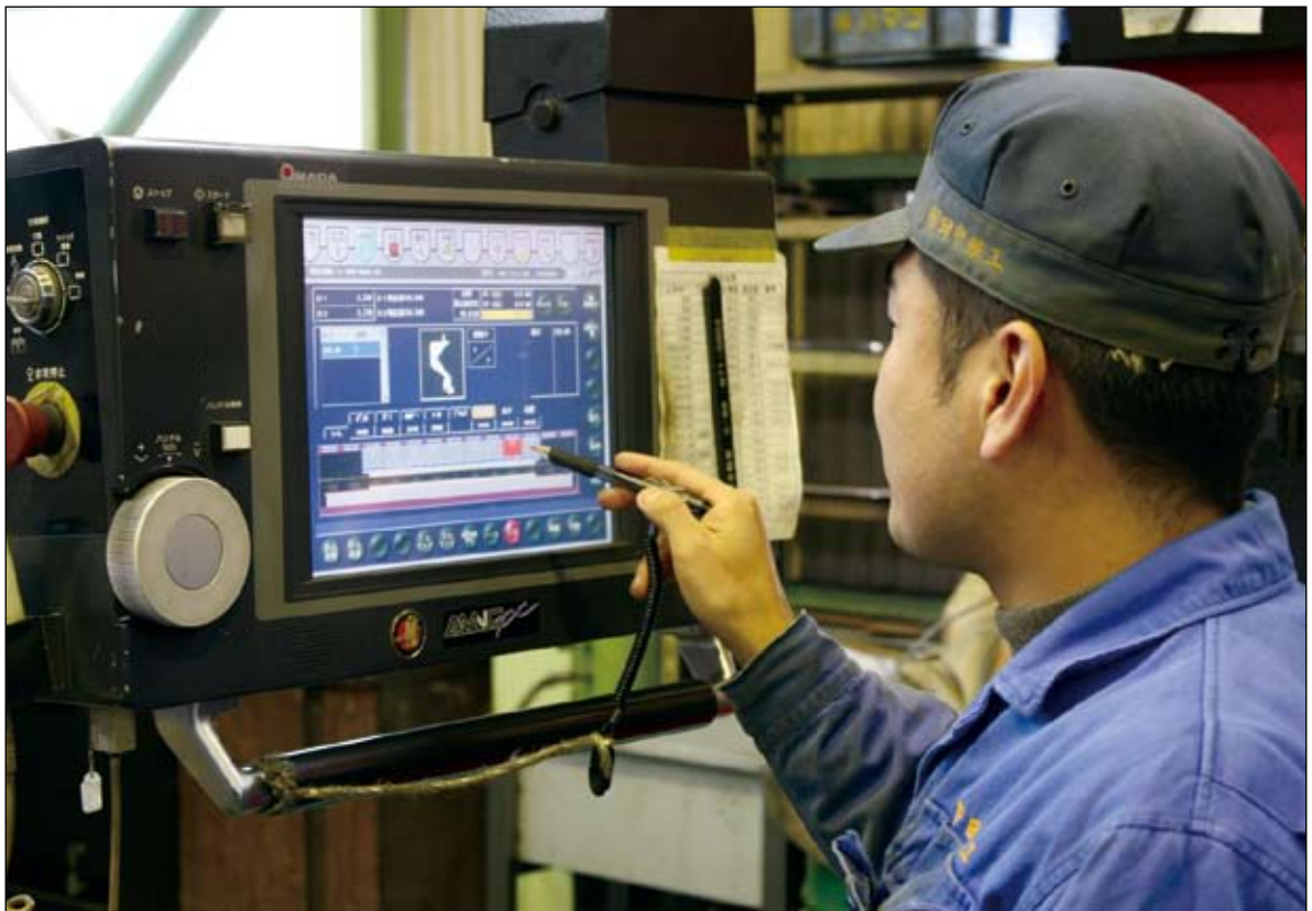
Dr.ABE_Bendが作成した曲げデータをNTベンダーのコントローラー AMNC/PCから呼び出す。
