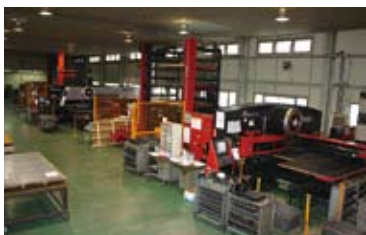
福田計器のブランク加工工場。EMZ、EML、LC-F1NTが並ぶ。
