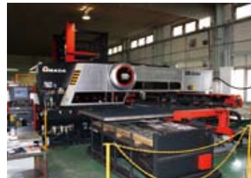
SUS304などステンレス材を中心に加工を行うEML-3510NT+ASR-48M+TKによるレーザー複合加工。
