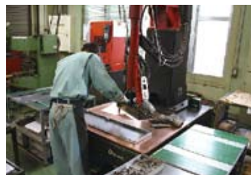
指示書を確認しながらテーブルスポット溶接で作業をする。
