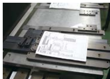
LC-3015F1NTで加工されたブランク材とバーコード付きの作業指示書。
