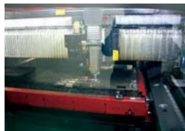
LC-3015F1NTでステンレス(SUS304、2mm材)の加工を行う。
