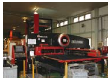
SPCなど3.2mm以下の鋼板を加工するEMZ-3510NT+ASR-48Mによるパンチング加工。
