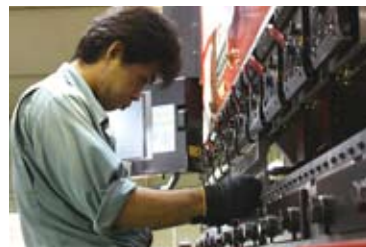
曲げ作業は2度づくり作業がなくなったため生産性が向上した。
