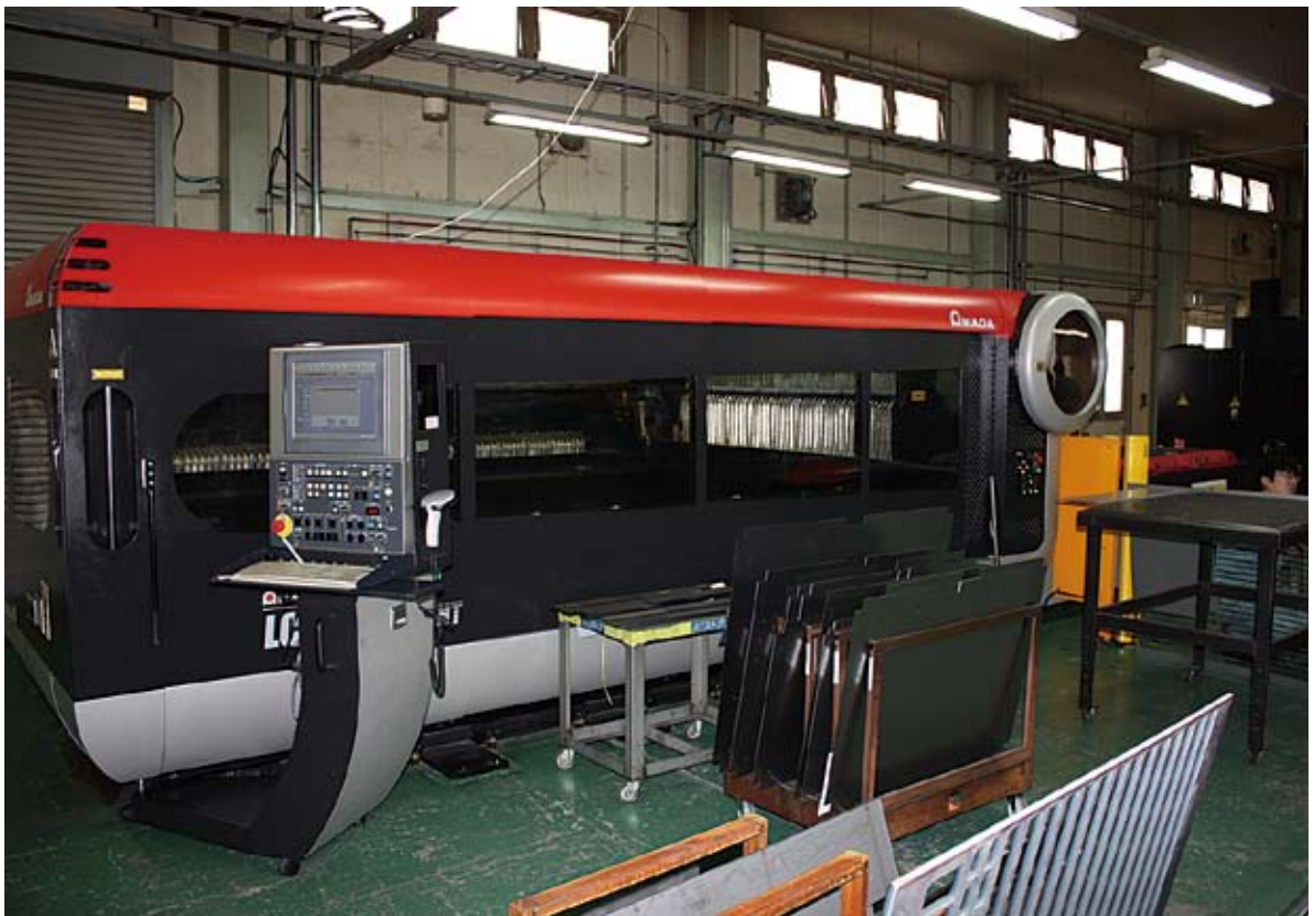
LC-3015F1NT+LST-3015F1 によるレーザー加工の生産性が2倍以上改善した。
