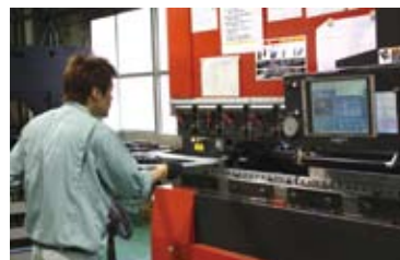
FBDⅢ-NTにより半導体検査装置部品の曲げ加工を行う。
