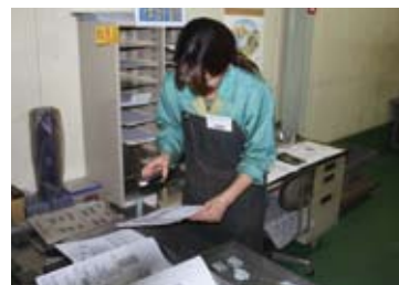
バーコード付き作業指示書を読み込み、進捗情報を送信。
