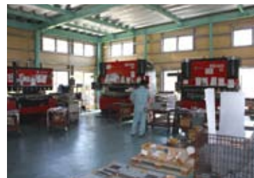
ネットワーク対応型ベンディングマシンが並ぶ第2工場。
