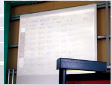
曲げ工程に設置された大型スクリーンを使ったデジタル・アンドン。
