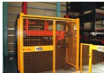
マイクロジョイントカッター(MJC)がネスティングに基づいて製品を仕分け加工する。
