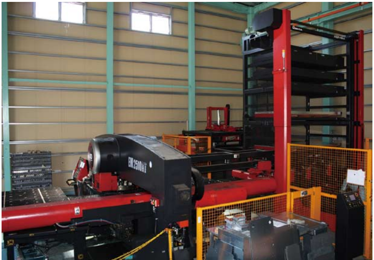
EM-2510NT+ASR-48M+MJC。サイクルローダーとマイクロジョイントカッターが装備され、24時間稼働を実現。
