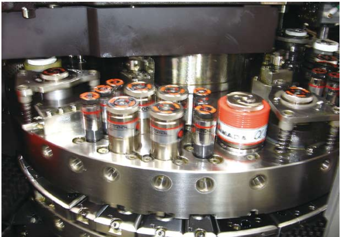
カセット装置を備えたAC-255NTのタレット。
