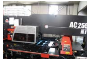
コンパクトな設計ながら、大容量タレットを備え、高速安定・高品質加工を実現。AC-255NTによるブランク加工。
