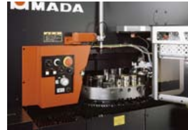
最大58本の金型搭載が可能な大容量タレット。
