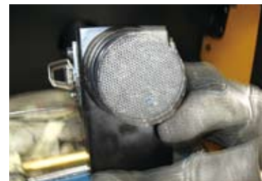
サクシヨンされたカスや細かなバリが残ったフィルター。カスサクシヨン装置の採用で99%以上のカスが吸引できた。
