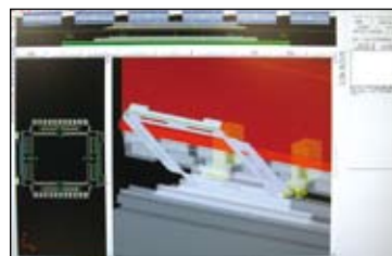
Dr.ABE_Bendによる曲げ加工可否作業。同社でのプラン率は90%あまりと高い。
