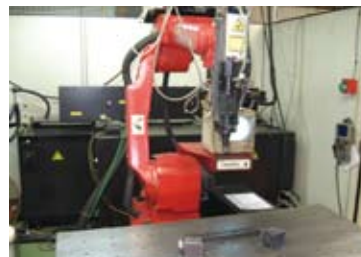
YAGレーザー溶接ロボットYLR-1500Ⅱ 2台が稼働する。
