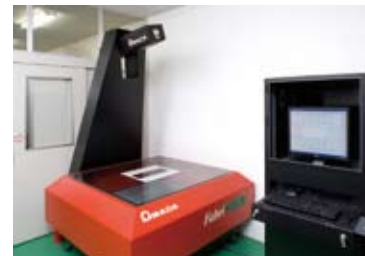
ブランク検査を非接触で行うLaser QC SheetWorks、AP100で展開したCADデータと照合が可能。
