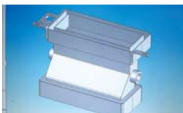
SheetWorksでモデリングした半導体製造装置に使用される板金ユニットの3次元モデル。
