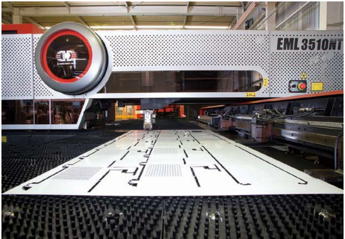
EML-3510NTP+ASR-48M+TKによるパンチ・レーザ加工。
