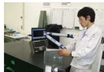
ポータブル3次元測定機FAROを使って曲げ加工が終わった製品検査を行う。SheetWorksで作成した製品モデルとの照合検査もできる。
