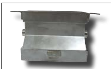
3次元データで作られた板金ユニット現物。
