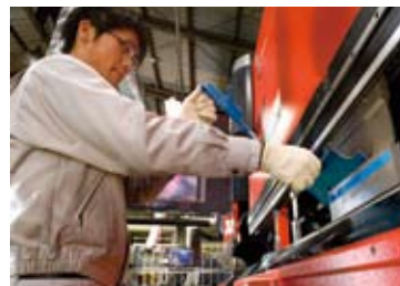
HDS-8025NTにより、保護シートを貼ったステンレス材を曲げ加工する。
