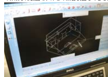
3次元測定機が測定した座標データと数値をSheetWorksで作成した3次元モデル上に表示する。
