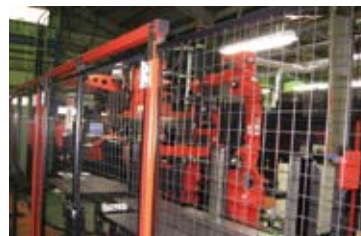
ASTROⅡ-100NTセルで小ロットの曲げ加工を行う。
