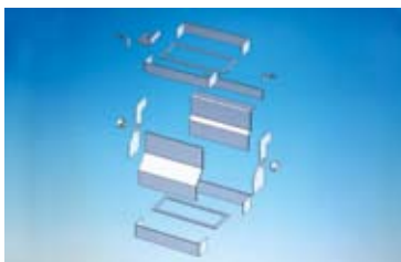
バッチ展開するために画面上でバラされた3次元モデル。
