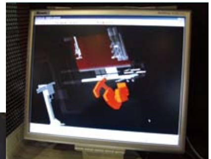
ベンディングロボットASTRO II-100NT用のオフラインプログラミング装置 Dr. ABE_ASTROによるプログラミング作業。
