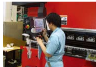
HDS-NT機のAMNC/PCで外段取りで作成された曲げデータを呼び出す。
