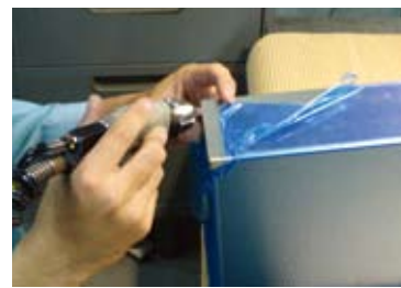
YAGレーザー溶接機によるステンレス材の突き合わせ溶接。
