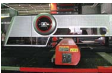
EML-3510NTでの最終加工は製品の外周をレーザー切断する。
