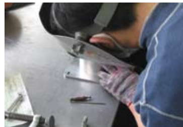
ジグを使いながら丁寧に溶接する。
