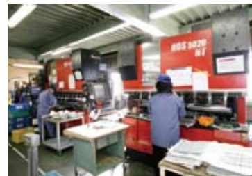
HDS-5020NTや8025NTなど4台のNTベンダーが並ぶ曲げ工程。
