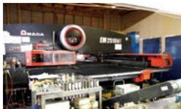
EM-2510NTは低騒音。より静音効果を狙って防音室に入れられて加工を行う。
