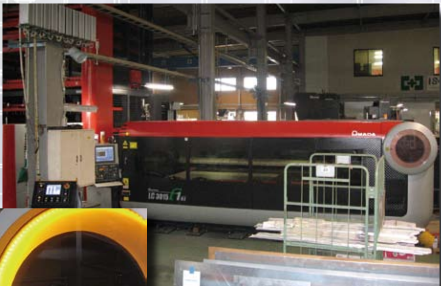
LC-3015F1NT+ASF-3015F1によるレーザ加工。
