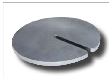
F1 加工例(SUS 6mm)面質が優れている。
