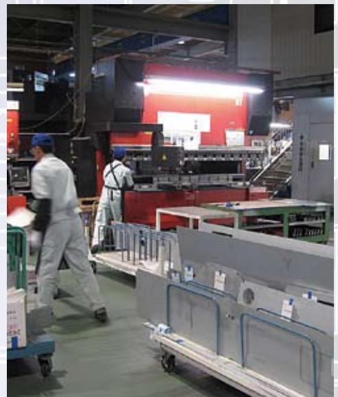
HDS-NT、FBDⅢ-NTによる曲げ加工エリア。ブランクは直に置かず台車に収納。
