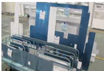
パライジングされた大型製品には縦置きの手車に格納、整理される。
