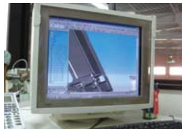
SheetWorks for Designで作成した3次元モデルで製造性を検証する。
