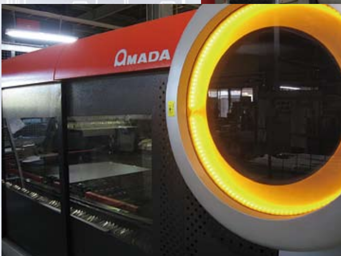
LC-3015F1NTの特長ある目玉は加工中にはオレンジ色に輝くシグナルタワーにもなる。
