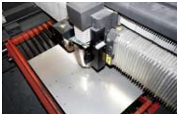
LC-3015F1NTによるステンレス薄板の切断。
