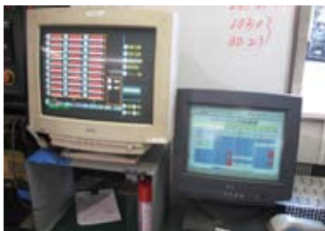
作業の着手、完了などの進捗情報を入力する現場端末。
