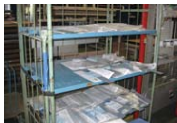
F1で加工された製品はバラタイジングされ現品票とともに小さな製品は棚に整理される
