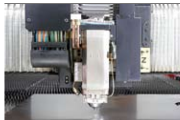
加工モニタリング機能を備えた加工ヘッド。
