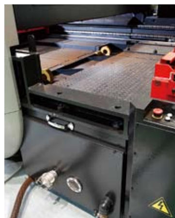
ビルトイン集塵機(オプション)は省スペース化と、マシン稼働率を改善。
