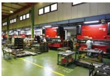
ブランク加工が終了した仕掛品は製品単位に台車に乗せられて曲げ工程に配膳される。
