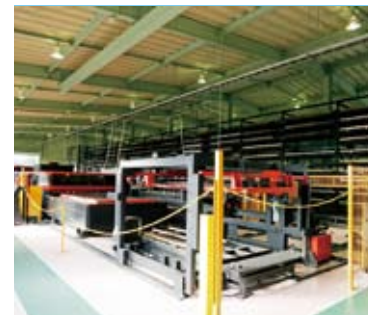
リニアドライブレーザーマシンFOL-3015NT +LSC-3015FOL+LST-3015FOLでSUSや薄板の高速切断と5×10'材に対応する。
