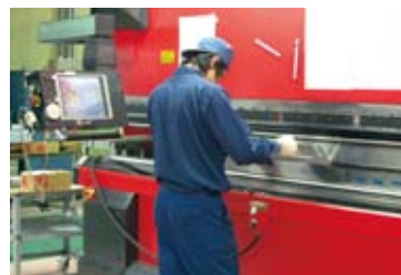
アマダモジュラーツーリングシステムを採用、HDS-1303 NTで高精度な曲げ加工を行う。
