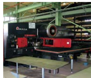
単品、単発の抜き加工に対応するパンチングマシンEMZ-3610NT。
