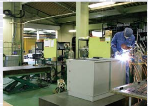
溶接工程でTIG溶接や酸素、アーク溶接を使って板金筐体の溶接を行う。
