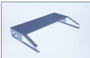
検査装置のテーブル部品をAP100で立体姿図でバーチャル試作する。
