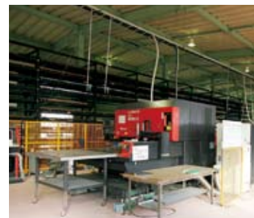
レーザーマシンLC-1212 α II で中・厚板の加工を行う。
