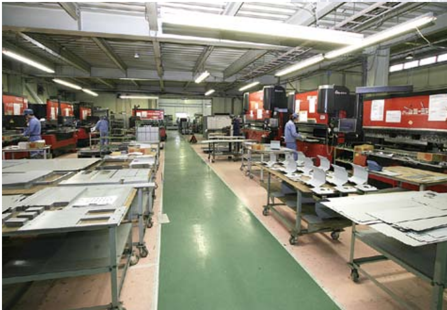
曲げ工程にはHDS-NT 2台、FBDⅢ-NT 4台、合わせて6台のネットワーク対応型ベンディングマシンが稼働している。
