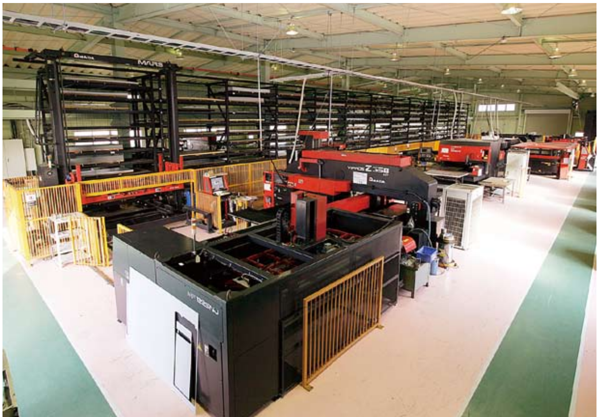
自動倉庫MARS10段13列を工場中央に配置してその両側にVIPROS Z-358NT PDC 2台、LC-1212αⅡ、FOL-3015NTの4台が並ぶ。
