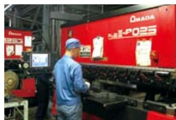
FBDⅢ-8025NTを使って曲げ加工を行うことで汎用ベンダーに比べて段取り時間が削減され、曲げの生産性が大幅に改善できた。
