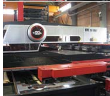
上：工場内部は工程順に設備がレイアウトされている。手前がパンチ・レーザー複合マシンAPELIO III。
