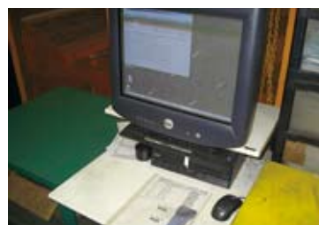
生産管理システムAPC21の現場クライアントから加工着手、完了情報を入力する。
