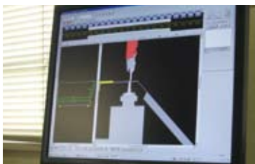
Dr.ABE_Bendで作成した曲げデータによるシミュレーション。
