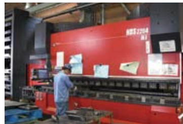
Dr.ABE_Bendで作成されたデータを使ってHDS-2204NTで長尺の曲げ加工を行う。
