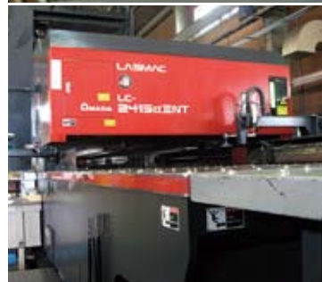
上：テイクアウトローダー(TK)で加工済みワークを集積する。
