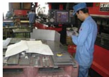
初回品に関しては曲げ加工が終わると角度を計測して曲げ精度を確認する。
