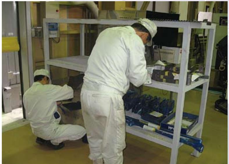
曲げ加工が終了した製品置き場の棚。バーコード付き現品票が1点ずつ添付されている。
