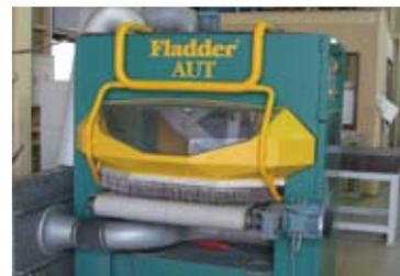
ステンレスなどの材料をブランク加工した後は3次元バリ取り装置、フラッターを使ってバリ取り加工を行う。
