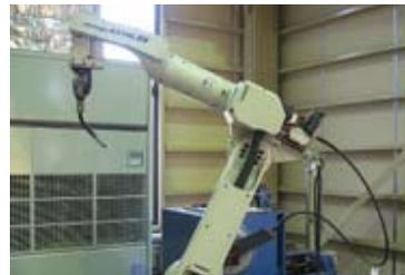
アーク溶接ロボット。将来はYAGレーザ溶接ロボットやTIG溶接ロボットの導入も計画している。
