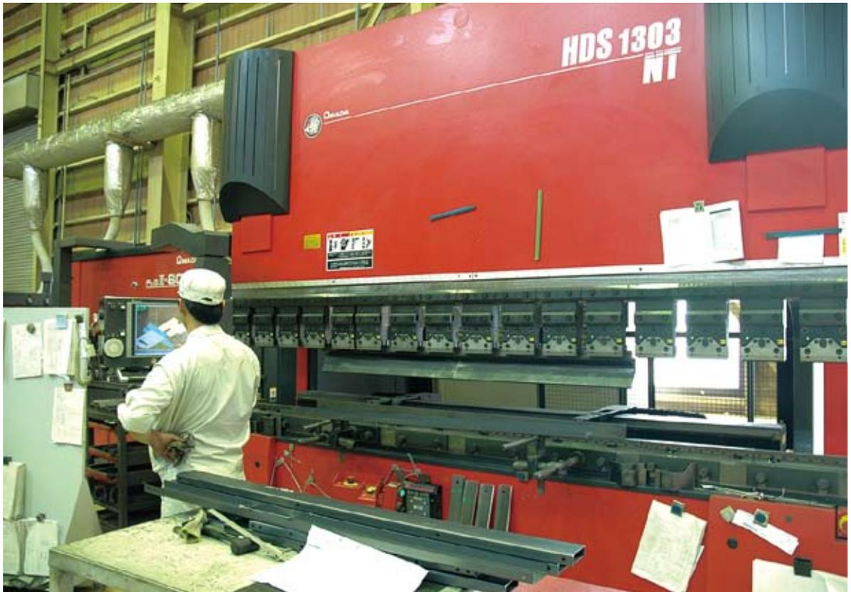
Bi-J付きのHDS-1303NTの前で加工する製品のデータを確認する。
