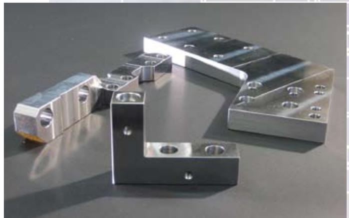
機械加工された部品。自動車を製作する機械の一部に使われる。材料:鉄15mm。
