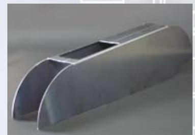
装置の中に組み込まれるチェーンのカバー。レーザー加工して折り曲げられた状態。この後、社内の次工程に廻される。材料:鉄。
