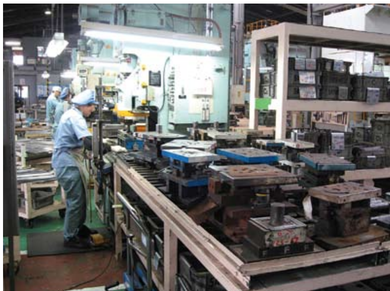
シングル段取りに対応したプレス加工ライン
