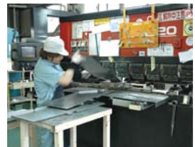
ベンディングマシンFBD III-5020Eによる曲げ加工
