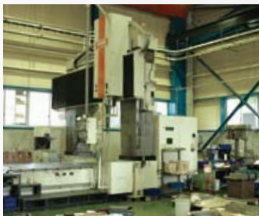
板金組立が終了したモジュールを大型五面加工機で仕上げ切削加工を行う。
