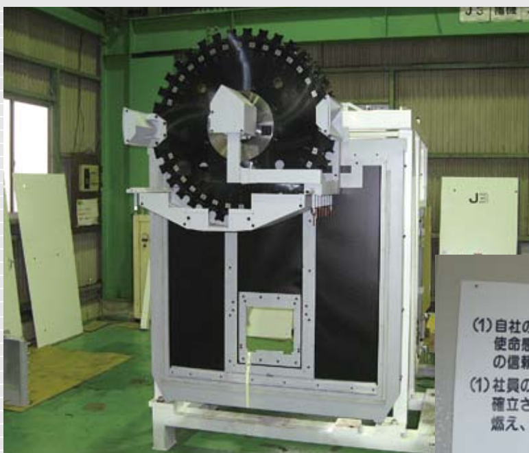
上：組立が終了して出荷を待つマシニングセンター用のATCとカバー。
