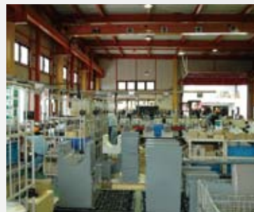
1個流し生産で加工、組立が行われるポンプ生産ライン。
