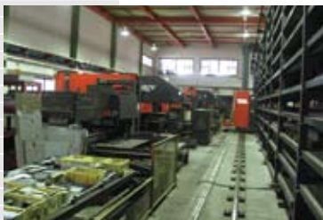
自動倉庫MARSと連動したAPELIO III-357で24時間連続稼働を行う。
