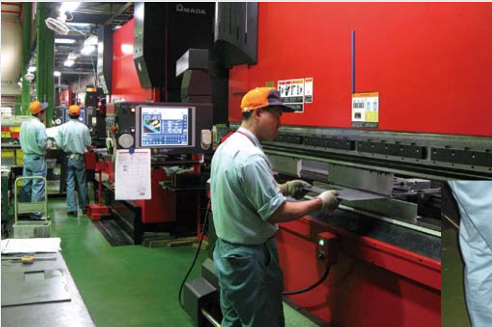
上：HDS-1303NTによる曲げ加工。2台目にはモジュラーツーリングシステムがセットされている。 右：2台目のHDS-1303NTにはフットスライドが自動的に移動するフットナビがついている。
