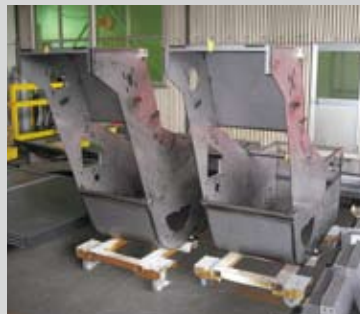
チップコンベヤー
