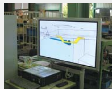
3次元CADデータの活用によって組立工数の削減と不良防止に役立っている。
