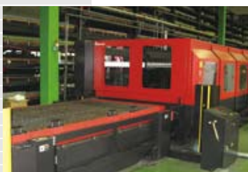
FO-3015NT+LST-3015FOは中・厚板のレーザ加工を行う。
