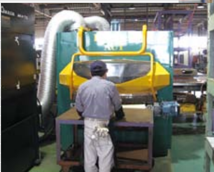
上：FBDⅢ-NT3台、HDS-NT3台など15台のベンディングマシンが並ぶ曲げ加工エリア。 左：ブランク加工後の加工品はフラッター社製の3次元バリ取り装置でバリを取る。
