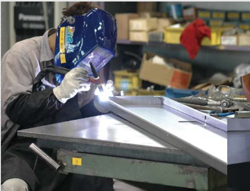
上：曲げ加工精度が向上し、溶接はアルゴン溶接が主体となった。 右：組立が終了した加工品例。
