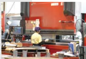
HDS-1303NTによる曲げ加工。
