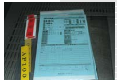
現場にはバーコード付き作業指示書が出される。現品票として最終工程まで加工品に添付されていく。
