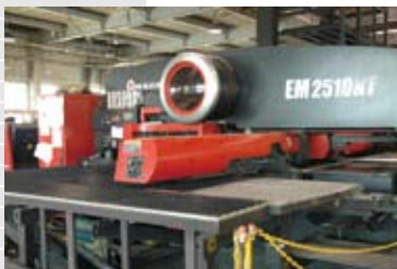
EM-2510NT+ASR-48Mは低騒音で環境に優しい。薄板を中心に加工する。
