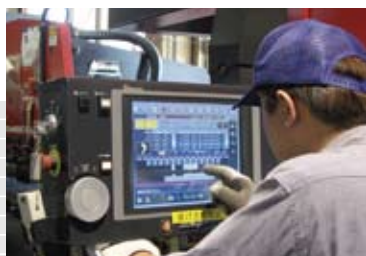
Dr.ABE_Bendが作成した曲げデータを呼び出して曲げ加工に着手する。
