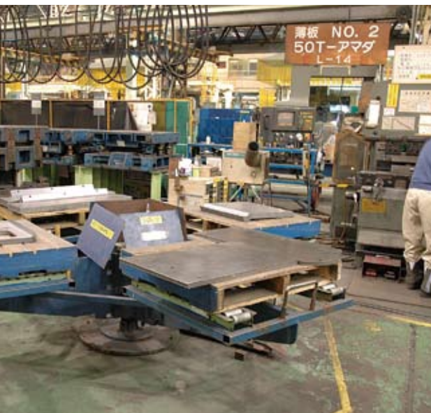
曲げ加工するブランク材と曲げ終了後のワークを回転式のパレットに載せて管理する
