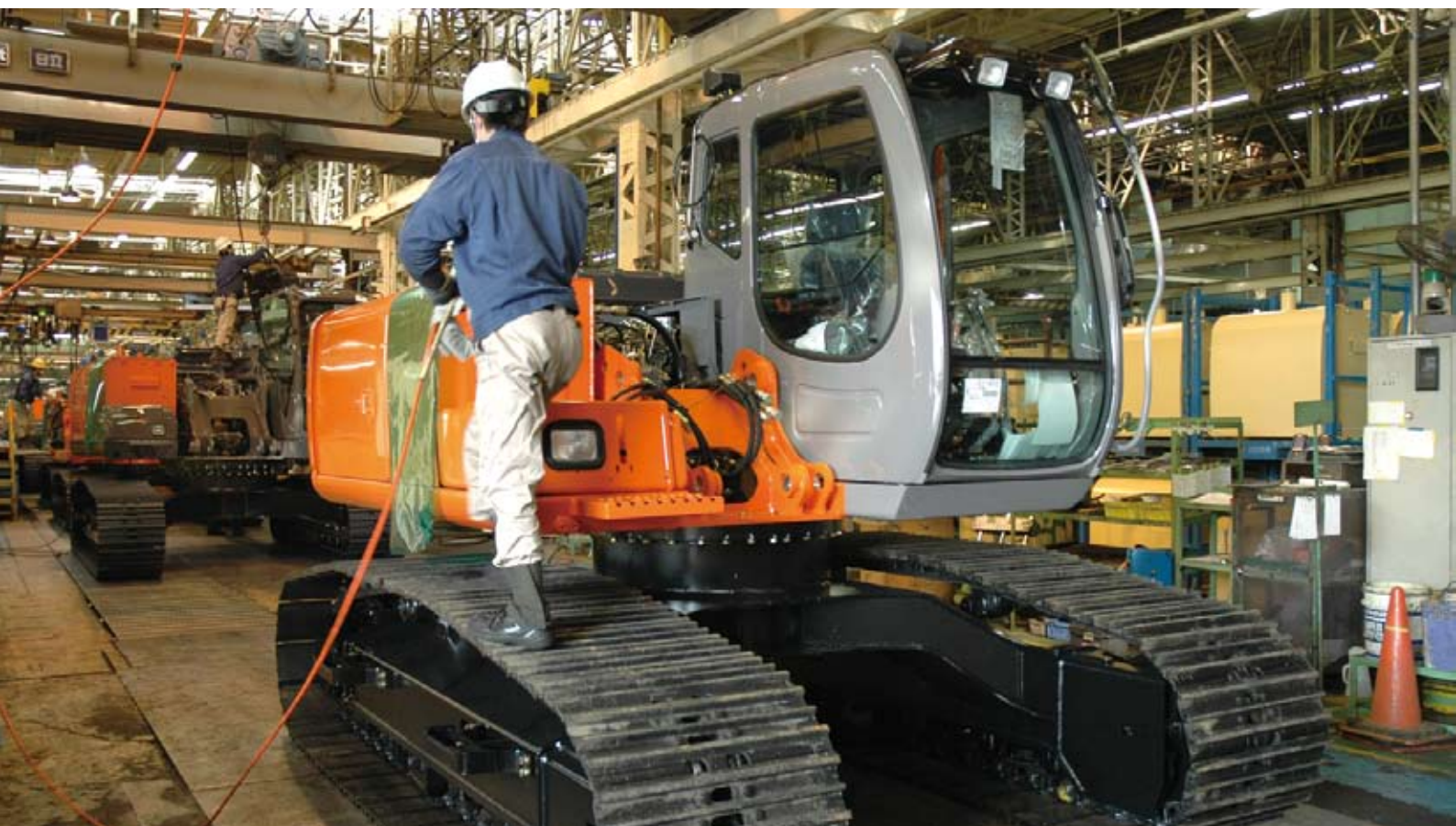
キャabinをはじめとした各種カバーの取り付けが終了したショベル
