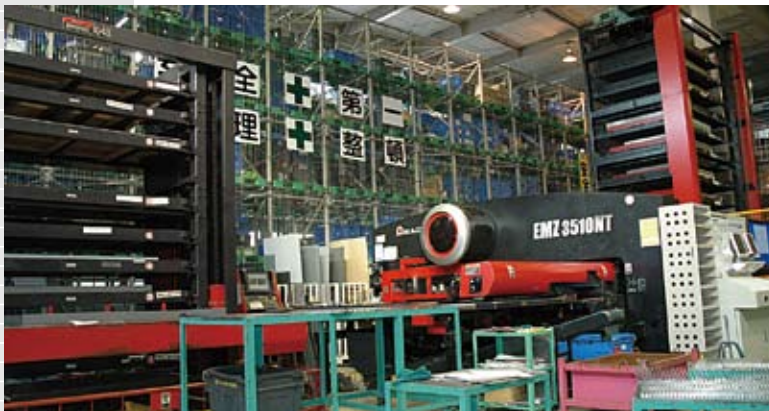
立体倉庫で工場内物流を管理するとともに、手前にはEMZ-3510NT+ASR-48Mが稼働している。
