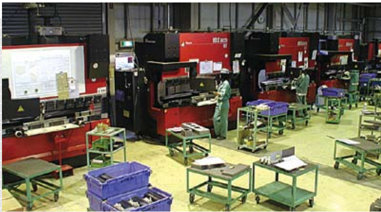
HDS-NT機4台、FBDⅢ-NT機3台を合わせて7台のNTベンダーがある。1台はVPSSスクリーン付き。
