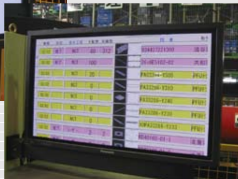
上：vFactory上に表示されているバーチャルファクトリー。 右：vFactoryは「工場見える化」ツール。加工着手、完了情報に基づいた加工実績、 機械稼働実績などの情報によって生産の実態を見る化する。
