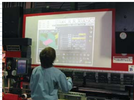
VPSSスクリーン付きHDS-8025NT。 現場加工編集会議ができるようにベンディングマシン の上部テーブルにVPSSスクリーンを装備。
