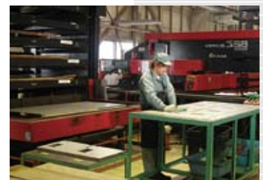
タレットパンチプレスによるブランク加工ライン。
