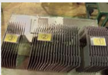
ロール目が曲げ精度に影響するので、ブランク材に番号をふったカンバンをつけて曲げ工程に送られる。
