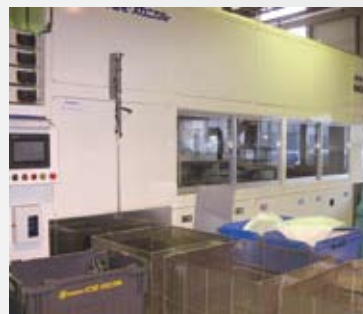
溶接やカシメで接合された製品は無公害洗浄装置で洗浄される。
