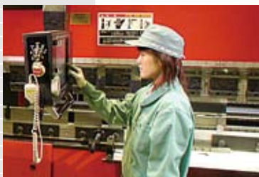
ロール目が変わるたびにD値補正を行う曲げ作業者。
