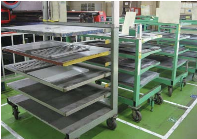
ブラッキングセンターで加工されたブランク材は機番ごとに棚台車に格納されて次工程の曲げショップに曲げ順に指定された置場に置かれる
