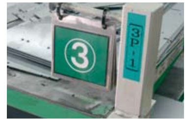
棚台車には曲げ加工する加工機と加工順が指示されている
