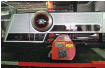
EML-3510NTでの最終加工は製品の外周をレーザー切断する。
