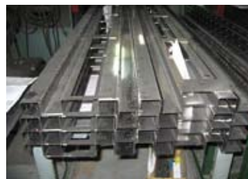
板金で剛性を持たすために曲げ加工で作成したフレーム。
