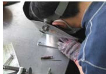
ジグを使いながら丁寧に溶接する。
