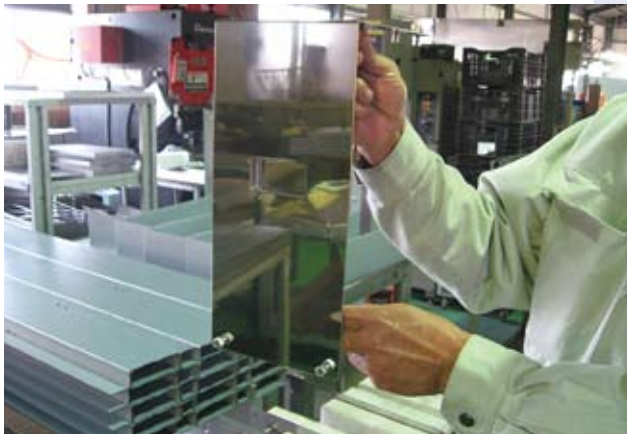
キズを付けないように細心の注意を払いながら組み立てられていく。
