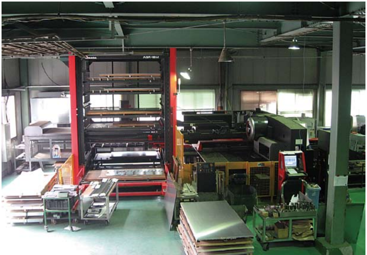
パンチ・レーザ複合マシンEML-3510NT+ASR-48M+TK、脇には白色ビニールで養生されたアルミが準備されている。
