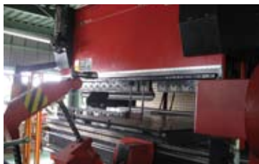
25曲げの通信関連中継ボックスを曲げ加工するASTRO-100NT。
