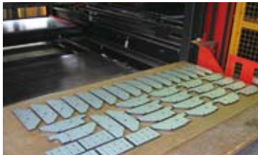
加工後、テイクアウトローダーで搬出パレットに整列して並べられた製品。
