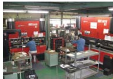
ネットワーク対応型ベンディングマシンは3台。向かって右側はモジュラーツーリング金型を装備したHDS-1030NT。
