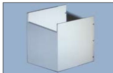
3次元ソリッド板金CAD SheetWorksでモデリングされた試作途上の筐体。
